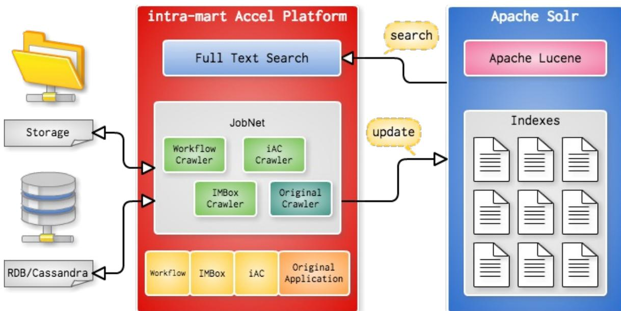
1. クローラ (JobNet) で全文検索対象となるコンテンツを生成し、Solrサーバのインデックスとして登録します。
